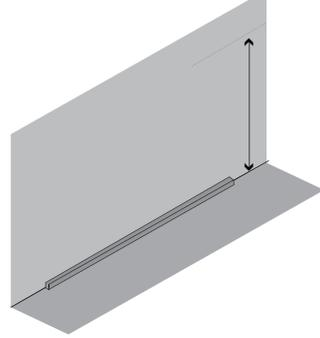
Misurare la distanza di **439 mm** per il posizionamento del profilo **D**
